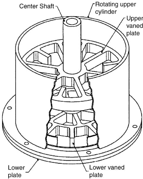
Fig. 2—Concrete rheometer.
